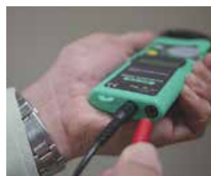
Bornes d'entrée standard (4mm) pour cordons normaux
