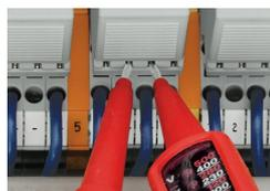
Tester le fonctionnement par simple contact protégé
