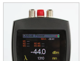
Mesure du niveau et affichage des pertes grâce à son entrée optique
