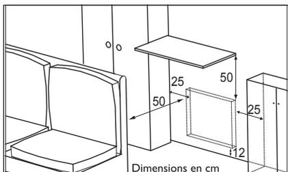
Respectez les distances minimales avec le mobilier pour l'emplacement de l'appareil.
