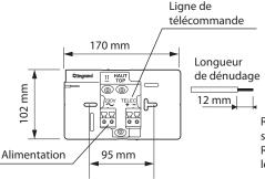
Raccorder les 2 fils d'alimentation sur les bornes secteur 230 V~ (bornier blanc). Raccorder la ligne de télécommande sur le bornier gris foncé.
