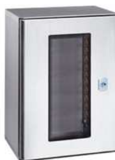
Réf 35221 Coffret Atlantic inox porte vitrée 304L- IP 66- IK10 Dimension 400x300x200 mm
